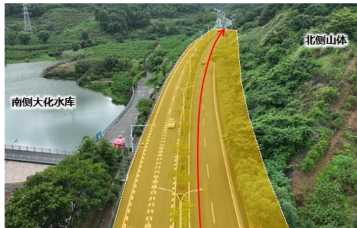
图 3-4 大化水库旁路段拓宽示意图
